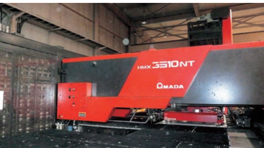
HMX-3610NT は、220本の金型を保有する ATC (自動金型交換装置) を備える
