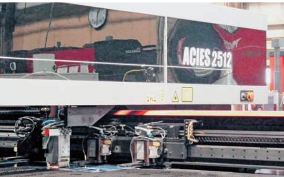
パンチング加工後、レーザーで外周加工しシートから切り離してから TK で機外へ搬出する
