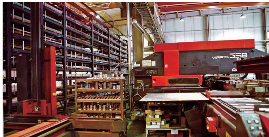
自動倉庫 MARS(10段6列)とリンクし、長時間自動運転が可能なVIPROS-358 King
