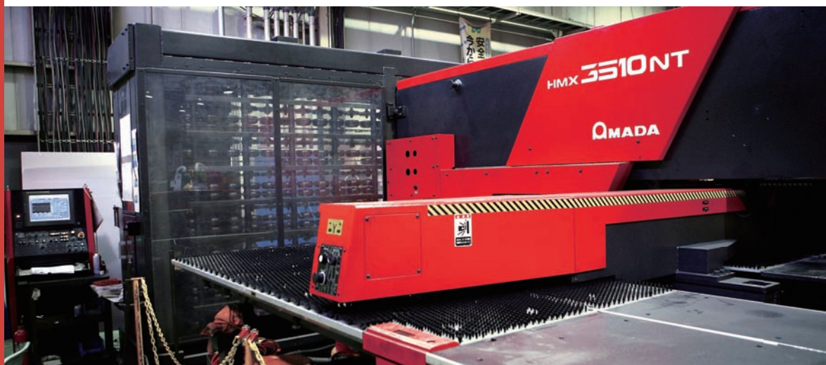
blanks工程の主力はパンチ241型・ダイ482型を装備するHMX-3510NT
