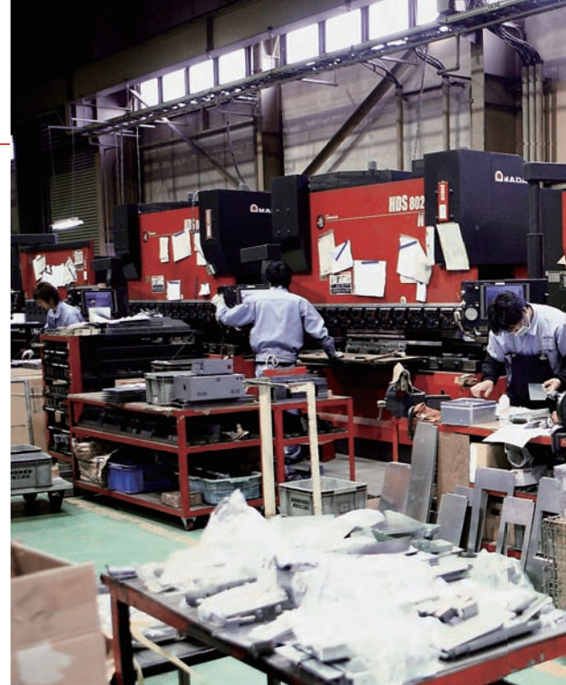
5台のネットワーク対応型ベンディングマシンが並ぶ曲げ工程
